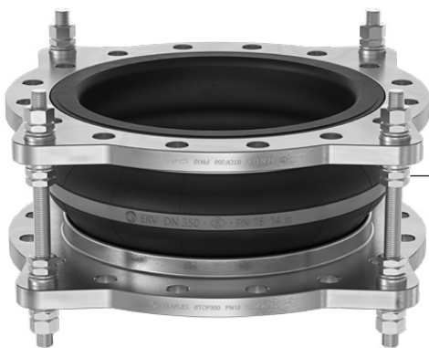
Innen- und Außenverspannung mit Kugelscheiben und Kegelpfannen nach DIN 6319, um Bewegung lateral zu ermöglichen Type ... ZSS (PN16 ab/from DN 250) (PN10 ab/from DN 300) Tie rods with inner and outer limitation in spherical discs and conical seats to DIN 6319 to allow lateral movement
