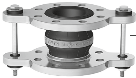
Außenverspannung mit Gummibuchsen Type ... ZS (PN16 bis/up to DN 200) (PN10 bis/up to DN 300) Tie rods with outer limitation in rubber bushings
